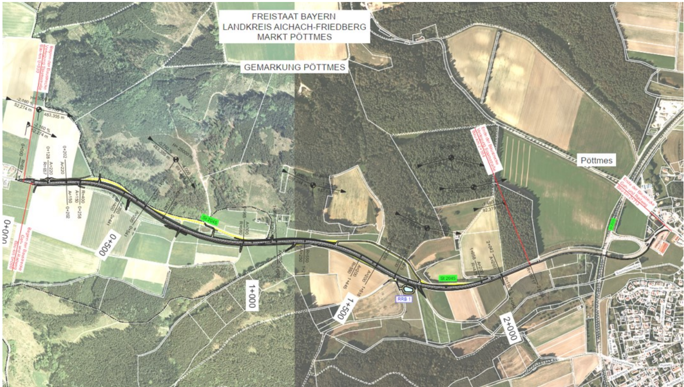
Eine verbesserte Trassierung gegenüber dem Altbestand (gelb) erhöht die Verkehrssicherheit erheblich – der neue Geh- und Radweg wird auf der Südseite angelegt
