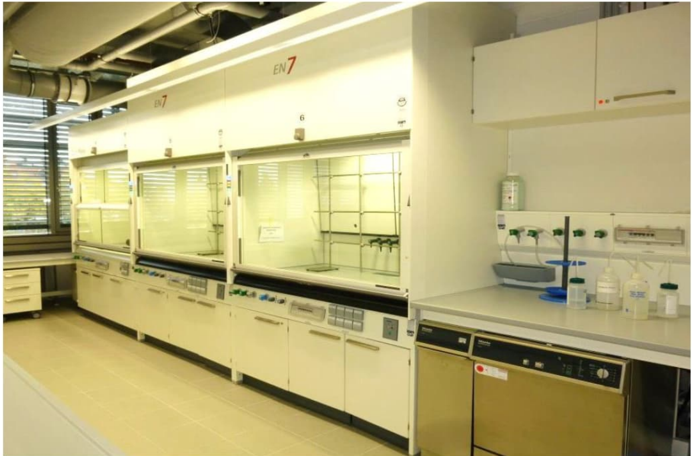
Laboreinrichtungen: Digestorien und Laborarbeitsstisch
