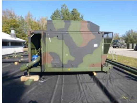
Hochdruckpumpenaggregat mit Saugleitung
