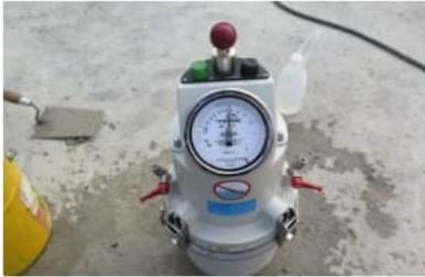
Prüfung des Beton-Luftporengehaltes (Kappenbeton)
