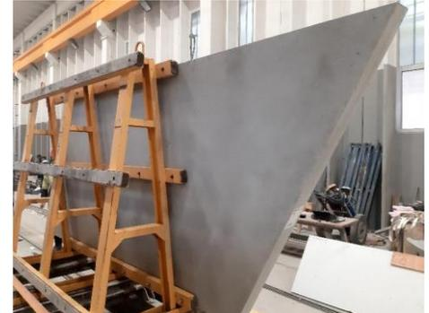
Ausgeschaltete Carbonbetonbohle im Fertigteilwerk
