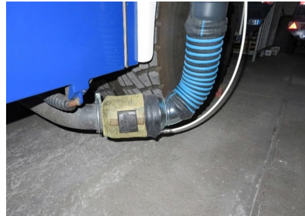
Sauginheit am Abgasrohr
